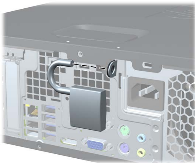
Figura 3-41 Instalación de un candado
