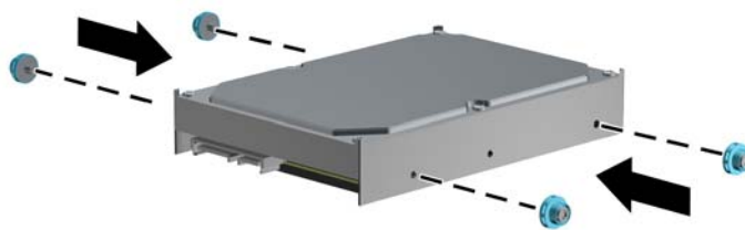
Figura 2-26 Instalación de los tornillos guía de montaje en una unidad de 3,5 pulgadas
