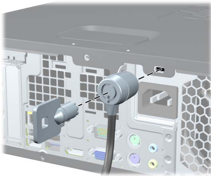
Figura 3-40 Instalación de un bloqueo de cable
