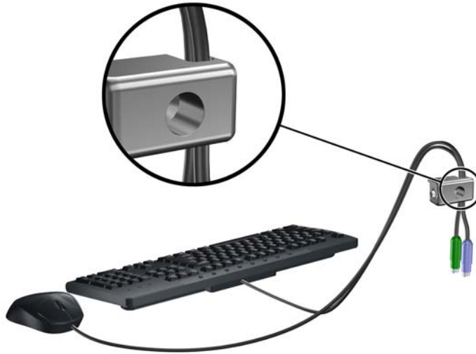
Figura 2-38 Enroscado de los cables del teclado y del mouse
