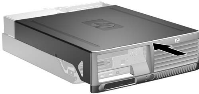
Figura 2-4 Colocación de la cubierta del equipo
