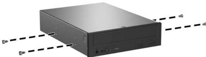
Figura 2-18 Instalación de tornillos de guía en la unidad óptica
