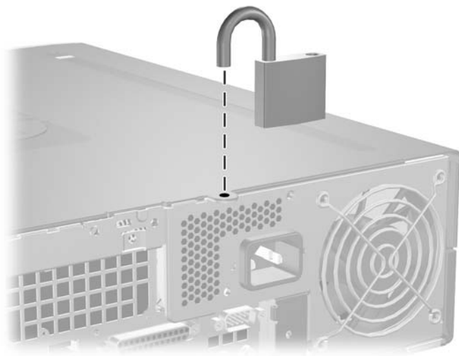
Figura C-2 Instalación de un candado
