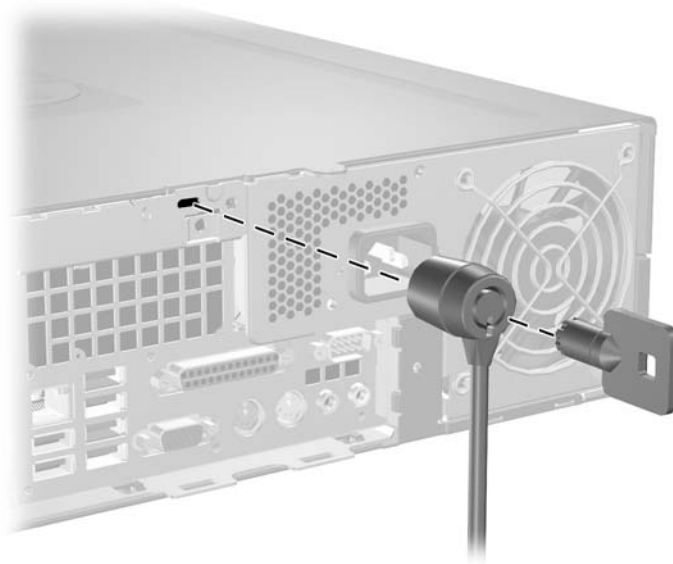
Figura C-1 Instalación de un candado con cadena
