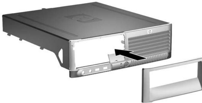
Figura 2-30 Instalación de un panel de unidad (se muestra una tapa de panel para una unidad de disco duro)
